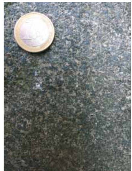
Lähikuva Hyvinkään gabrosta Jaanankalliolta. Vaalea mineraali on plagioklaasimaasälpä ja tummat pääasiassa pyrokseenin ja sarvivälkkeen sekoitusta (pyrokseeni on osittain tai kokonaan muuttunut sarvivälkkeeksi syvällä maankuoressa kiertäneiden kuumien liuosten vaikutuksesta). Kvartsi loistaa poissaolollaan!
