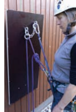
Kuva 5: Liidaajan kiinnittyminen ketjuankkuriin 2
